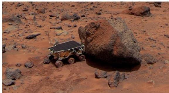
En radioaktiv källa emitterar  $\alpha$ -partiklar, vilka vid kollisionen med stenen ger upphov till Röntgenstrålning. Genom att analysera denna strålning kan man bestämma den geologiska sammansättningen av föremål på Mars yta. Röntgenspektrat nedan kommer från "Barnacle Bill" och 2 av de karakteristiska  $K\alpha$ -linjerna, med fotonenergin 1,75 respektive 6,49 keV, har markerats. Bestäm vilka 2 grundämnen som ger upphov till dessa linjer.
