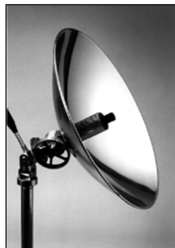
Figur 3 En Stirlingmotor försedd med en parabolspegel som fokuserar solljus på motorns yttersta del.
