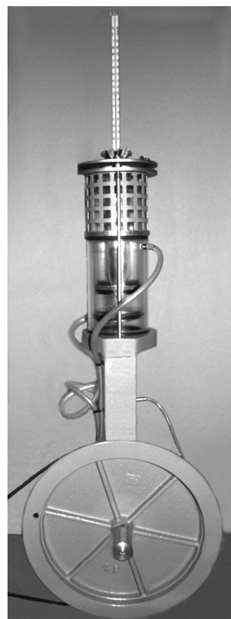
Figur 7 Svänghjulet på Stirlingmotorn kan drivas runt av en elektrisk motor. Varje gång kretsprocessen genomlöps tar arbetsgasen upp värme som sedan antingen avges till kylvattnet eller till den del där termometern sitter.
