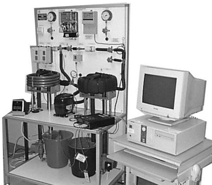
Figur 8. Laborationens värmepumpsanläggning med inkopplat mätsystem.
